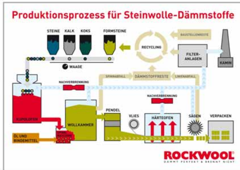
Abbildung 2: Verfahrensschritte zur Produktion von Steinwolle-Dämmstoffen
