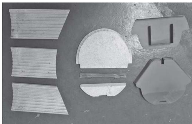
Das Wiedereinsetzen der Feuerraumauskleidung erfolgt in umgekehrter Reihenfolge. Achten Sie bei den seitlichen Feuerraum-Auskleidungsteilen und dem hinteren Feuerraum-Auskleidungsteil auf die Position der Tertiärluftlöcher.
